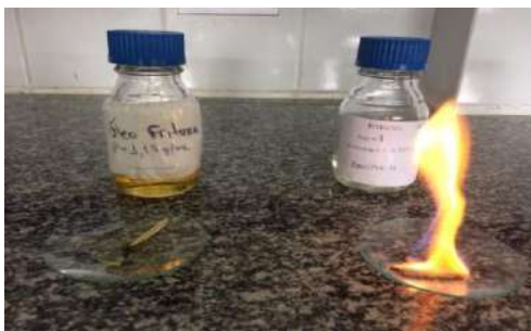
Figura 2. Teste de chama realizado para o biodiesel (direita) e óleo de fritura (esquerda)
