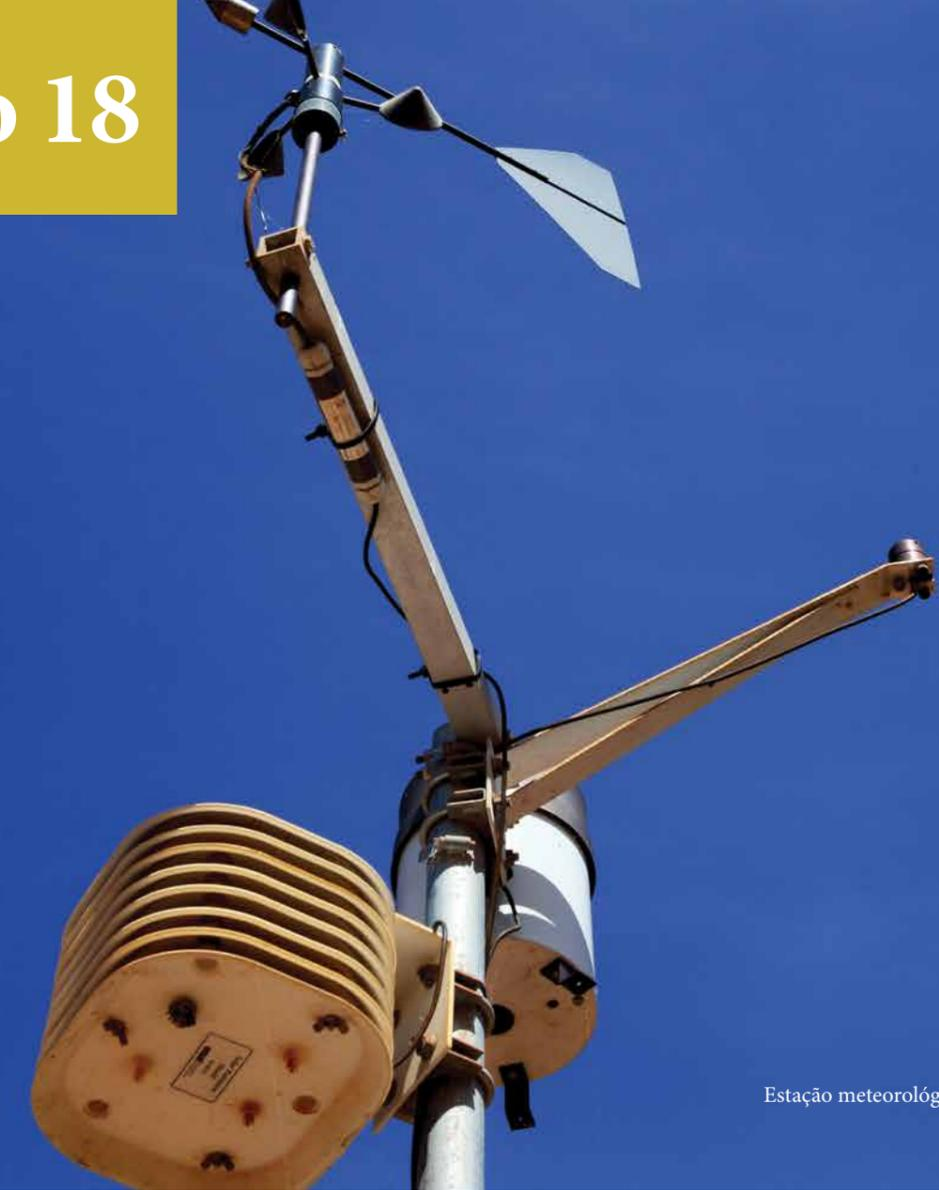
Estação meteorológica na Estação Experimental da UFERSA. Foto: Dirk Koedam
