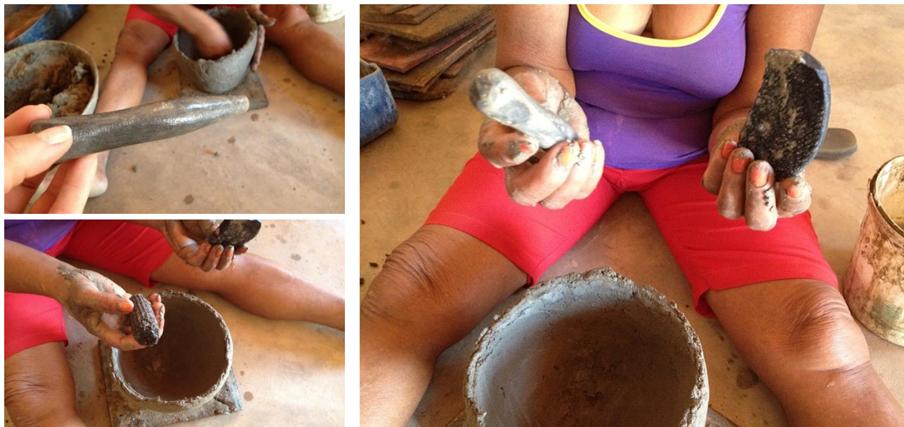
Figura 2. Cabos de vassoura, pedaços de sandálias de borracha e sabugos utilizados como ferramentas de desbaste e alisamento
